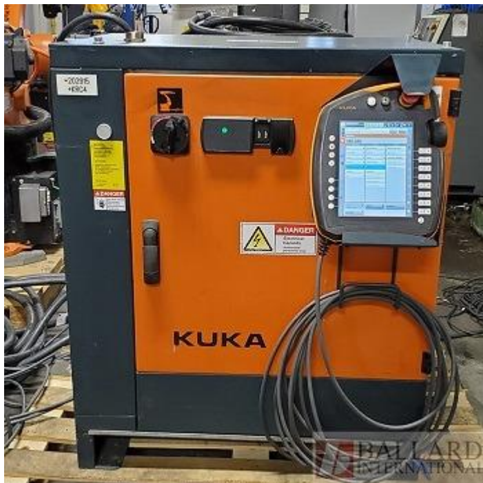
Figura 2. Painel elétrico de comando e unidade de controle e programação, Kuka KR 210 R3100 ULTRA KRC4
